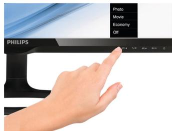
Les commandes SmartTouch sont des touches tactiles intelligentes qui remplacent les boutons saillants. Sensibles au moindre contact, les commandes SmartTouch permettent notamment de mettre le moniteur sous tension ou de régler la luminosité et la netteté de l'afficheur à l'aide de la technologie SmartImage Lite. Lorsqu'elles sont activées, les touches SmartTouch s'allument pour indiquer que votre commande a été exécutée.
