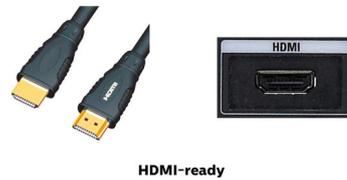
Un appareil compatible HDMI est équipé de l'ensemble du matériel requis pour accueillir une entrée HDMI (High-Definition Multimedia Interface). Un seul câble suffit pour transmettre des signaux audio et vidéo numériques de haute qualité à partir d'un PC ou d'un large éventail de sources audio/vidéo (décodeurs, lecteurs de DVD, récepteurs audio/vidéo et caméscopes).
