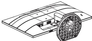
2. Нажмите фиксаторы, чтобы отсоединить подставку монитора от основания.
