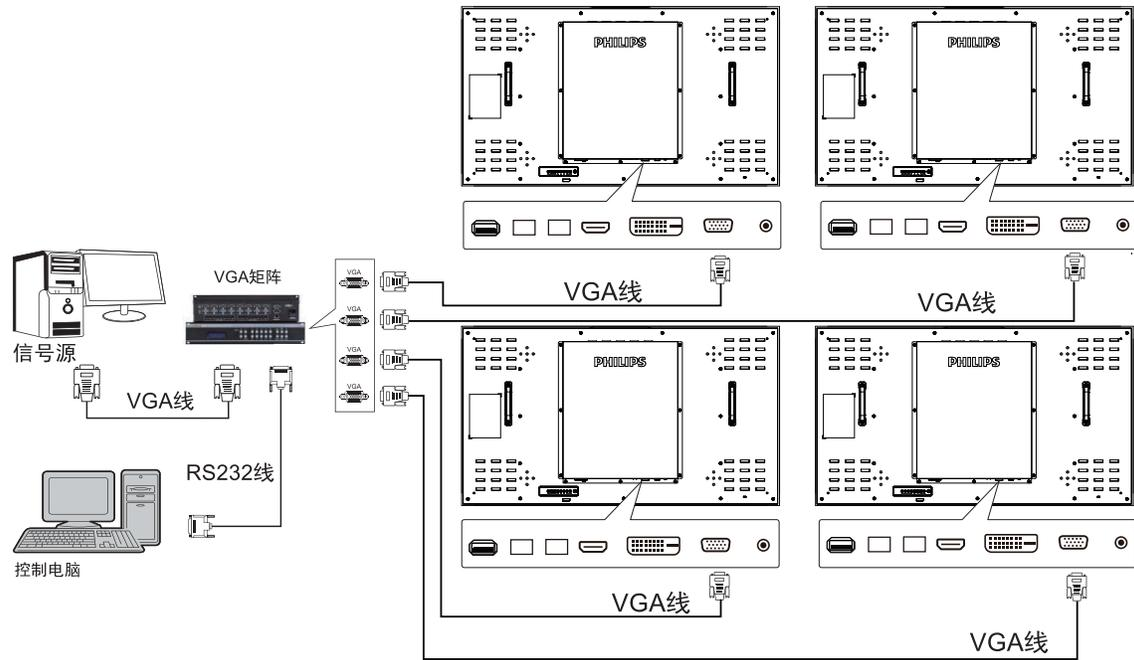
注：将信号源输出接矩阵的输入端，通过矩阵的输出端将信号连接到多台机器的VGA，矩阵的RS232 串口用RS232 线连接控制电脑。
