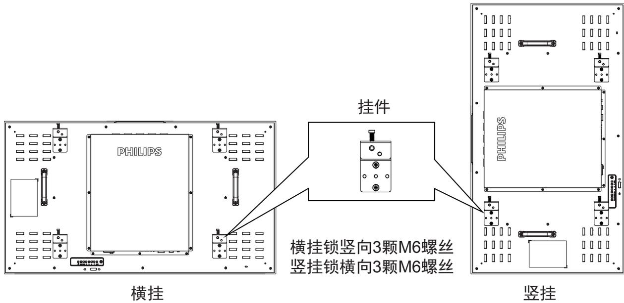
3. 将螺丝固定完毕，可将机器挂墙或拼接支架上。
