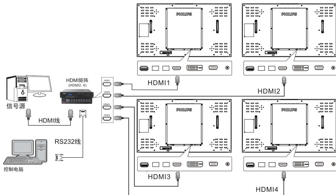
注: 将信号源输出接矩阵的输入端, 通过矩阵的输出端将信号连接到多台机器的 HDMI, 矩阵的 RS232 串口用 RS232 线连接控制电脑。
