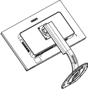
2. Afloje los tornillos de ensamblaje y, a continuación, desmonte el cuello del monitor:
