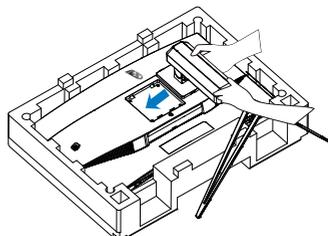
3. Depois de encaixar a suporte, levante o monitor com ambas as mãos segurando-o firmemente em conjunto com a placa de esferovite. Em seguida, poderá remover o esferovite. Tenha em atenção que tem um design curvo, quando retirar a placa de esferovite, não pressione o ecrã para evitar a quebra do mesmo.
