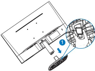
3. Trykk på utløserknappen for å løsne skjerm søylen.
