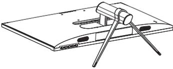
2. Quite la tapa de la bisagra del cuerpo del monitor con una herramienta auxiliar.
