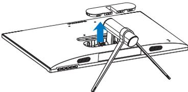
3. Utilice un destornillador para quitar los tornillos del brazo y, a continuación, desmonte el brazo y el pie del monitor.
