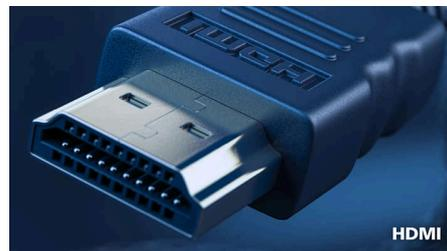
Un dispositivo compatible con HDMI tiene todo el hardware necesario para admitir una entrada de interfaz multimedia de alta definición (HDMI). Un cable HDMI permite transmitir audio y vídeo digitales de alta calidad a través de un solo cable
