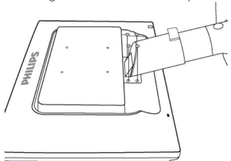
2. Quite los 4 tornillos y retire la base del monitor LCD.
