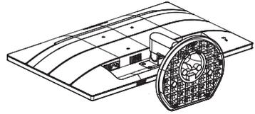
2. Presione los broches de bloqueo para desmontar la base de la col.
