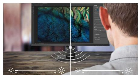
PowerSensor je ugrađeni senzor za prepoznavanje korisnika koji odašilje i prima infracrvene signale koji nisu štetni radi određivanja nalazi li se korisnik ispred monitora te omogućava automatsko smanjenje svjetline monitora kada se korisnik udalji od stola, čime se troškovi za energiju smanjuju za do 75 posto i produžuje vijek trajanja monitora.
