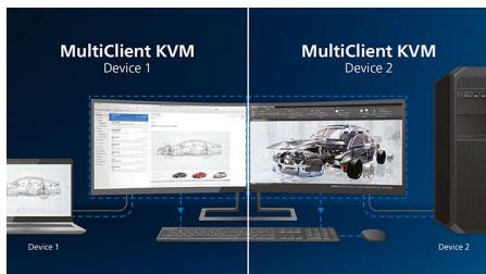
MultiClient integrirana KVM sklopka omogućava kontrolu dva zasebna računala pomoći jednog monitora, tipkovnice i miša. Praktičan gumb omogućava brzo prebacivanje između izvora. Pogodno za konfiguracije koje zahtijevaju dvostruku računalnu snagu ili dijeljenje jednog velikog monitora za prikaz dva različita računala.
