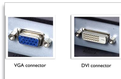
Dual Input bietet Anschlüsse für den Eingang von analogen VGA-Signalen und digitalen DVI-Signalen.
