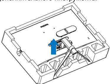
3. Отверткой открутите винты на кронштейне и снимите кронштейн/подставку с монитора.
