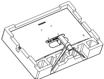
2. Снимите шарнирную крышку с корпуса монитора с помощью дополнительного инструмента.
