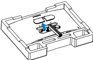
4. 使用螺丝刀卸下支撑臂上的螺丝，然后从显示器分离支撑臂 / 支架。
