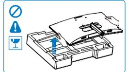
2. (1) 用双手拿住底座支撑臂，用力将底座支撑臂插入底座支撑柱。
