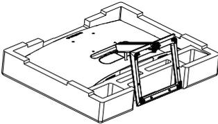
2. 用螺丝刀拧开位于底座底部的螺丝，从底座上拆下显示器。
