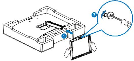
3. 安装底座后，用双手抓住与塑料泡沫紧扣在一起的显示器，使显示器直立。现在可以拔出泡沫塑料了。注意本显示器采用弯曲设计，拔出泡沫塑料时，不要挤压面板以避免损坏面板。
