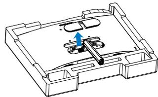
4. 使用螺丝刀卸下支撑臂上的螺丝，然后从显示器分离支撑臂 / 支架。
