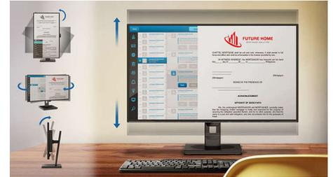
A SmartErgoBase é uma base para monitor que proporciona um grande conforto ergonómico de visualização e permite uma arrumação inteligente dos cabos. A base pode articular, inclinar e rodar para vários ângulos para garantir o máximo conforto. O suporte com altura ajustável garante um nível de visualização ideal, alivia o esforço físico de um longo dia de trabalho, enquanto a arrumação inteligente dos cabos reduz a desordem de cabos e mantém a área de trabalho organizada e profissional.
