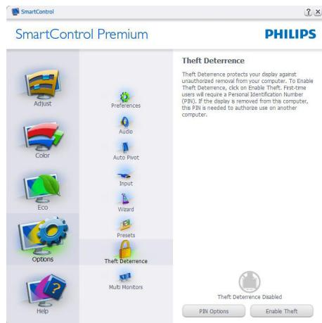
Da biste omogućili Theft Deterrence (sprečavanje krađe), kliknite na taster Enable Theft Deterrence Mode (omogući sprečavanje krađe), koji će pokrenuti sledeći ekran:
