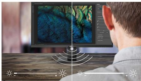
O PowerSensor é um "sensor de pessoas" incorporado que transmite e recebe sinais infravermelhos inofensivos para determinar a presença do utilizador e reduzir automaticamente o brilho do monitor quando o utilizador se afasta da secretária, reduzindo os custos de energia em até 80% e prolongando a vida útil do monitor.
