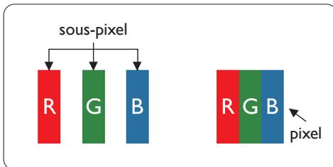
Ein Pixel oder Bildelement besteht aus drei Subpixeln in den Grundfarben Rot, Grün und Blau. Bilder werden durch eine Zusammensetzung vieler Pixel erzeugt. Wenn alle Subpixel eines Pixels erleuchtet sind, erscheinen die drei farbigen Subpixel als einzelnes weißes Pixel. Wenn alle drei Subpixel nicht erleuchtet sind, erscheinen die drei farbigen Subpixel als einzelnes schwarzes Pixel. Weitere Kombinationen beleuchteter und unbeleuchteter Pixel erscheinen als Einzelpixel anderer Farben.
