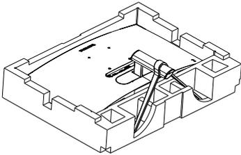
2. Entfernen Sie die Scharnierabdeckung mit dem Hilfswerkzeug vom Monitorgehäuse.
