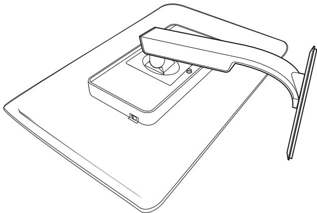
2. Вийміть гвинти з покриття петель.
