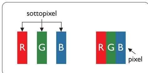
Un pixel, o elemento di immagine, è composto da tre sottopixel, uno per ogni colore primario (rosso, verde e blu). Un'immagine è formata da un insieme di pixel. Quando tutti i sottopixel di un pixel sono illuminati, i tre sottopixel colorati appaiono come un singolo pixel bianco. Quando sono tutti spenti, i tre pixel secondari colorati appaiono insieme come un pixel nero. Le diverse combinazioni di sottopixel illuminati e spenti formano i vari colori.
