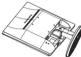
2. Apăsați pe clamele pentru blocare pentru a demonta suportul din șanțul special.
