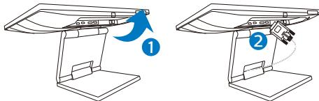
1. 将连接线牢固连接到显示器背面插口。
