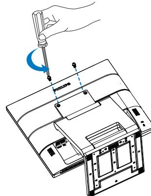
2. 如图所示，将支架移动到位。然后用螺丝刀拆下螺丝，再将支架从显示器上拆下。
