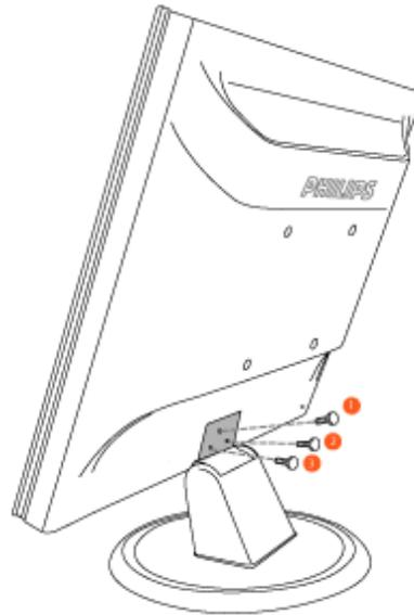
**Nota:** Il monitor è predisposto per un'interfaccia di montaggio 100 mm x 100 mm, conforme a VESA.
