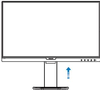
2. モニタ面を下にして、滑らかな面に置きます。画面にひっかき傷が付いたり損傷したりしないように注意してください。モニタスタンドを持ち上げます。
