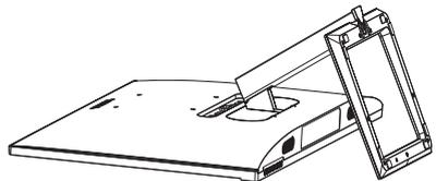
2. Utilize uma chave de fendas para desapertar o parafuso da parte
