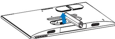
4. Utilize uma chave de fendas para remover os parafusos da coluna e desencaixe a coluna/suporte do monitor.
