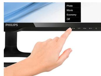
Dodirne kontrole su napredni, na dodir osjetljivi gumbi koji zamjenjuju izbočene tipke i pomoću kojih korisnik monitor može podestiti prema vlastitom nahođenju. Dodirne kontrole reagiraju i na najblaži dodir, a monitor zahvaljujući njima djeluje moderno.
