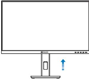
2. Coloque o monitor virado para baixo sobre uma superfície macia. Tenha cuidado para não riscar ou danificar o ecrã. Em seguida, levante a base do monitor.
