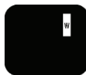
Tre angränsande subpixlar lyser (en vit pixel)
