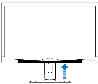
2. Umístěte monitor obrazovkou dolů na měkký podklad. Zabraňte poškrábání nebo poškození obrazovky. Potom zvedněte stojánek monitoru.
