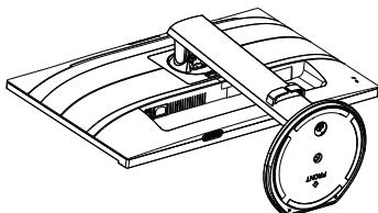
3. Нажав кнопку фиксатора, наклоните основание и извлеките его.
