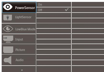
コントロールキーの基本および簡単な指示上に示したOSDで、モニタの前面ベゼルの▼▲ボタンを押してカーソルを動かしたり、OKボタンを押して選択または変更を確認できます。
