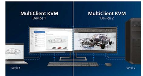
Grâce au commutateur KVM multiclient intégré, vous pouvez contrôler deux PC distincts avec un seul système moniteur-clavier-souris (KVM). Un bouton commode vous permet de basculer rapidement entre les sources. Pratique pour les installations nécessitant la puissance de calcul de deux PC ou lorsque vous souhaitez utiliser un seul grand moniteur pour afficher le contenu de deux PC différents.
