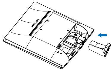
3. 請用雙手緊握顯示器底座支架，並將底座支架確實裝入底座安裝座中。
