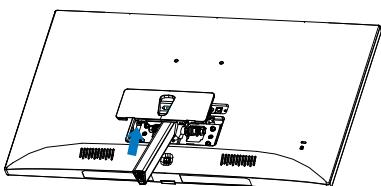
4. Отверткой открутите винты на кронштейне и снимите кронштейн/подставку с монитора.
