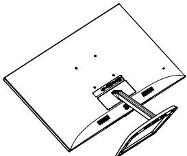
2. Пальцами ослабьте винт с обратной стороны подставки и снимите ее со стойки.
