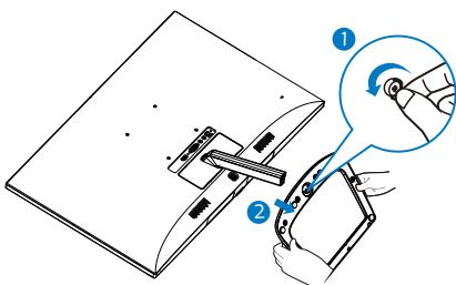
3. Снимите руками крышку шарнира с корпуса монитора.
