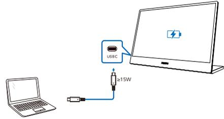
Il monitor può essere alimentato dal dispositivo tramite USB-C che supporta fino a 65 W con 5 V/3 A, 7 V/3 A, 9 V/3 A, 10 V/3 A, 12 V/3 A, 15 V/3 A, 20 V/3, 25 A
