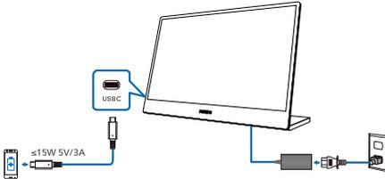
La porta USB-C di questo monitor è in grado di fornire 15 W e 5 V/3 A di alimentazione per caricare il dispositivo.
