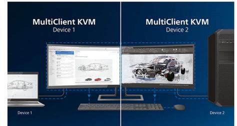
С переключателем KVM для интеграции MultiClient вы можете управлять двумя разными ПК с одной конфигурации монитор/мышь/клавиатура. Удобная кнопка позволяет быстро переключаться между источниками. Подойдет для конфигураций, требующих вычислительной мощности двух ПК или для тех, кто использует один большой монитор для работы с двумя разными ПК.
