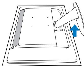
2. Stlačením zaistovacích svoriek odpojte podstavec od ramena podstavca.
