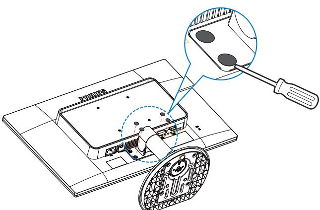
3. Uklonite odvijače s poklopca zgoba.
