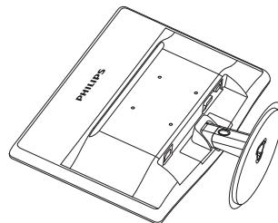
2. 壓下鎖定夾可分離底座支架與底座安裝座。
