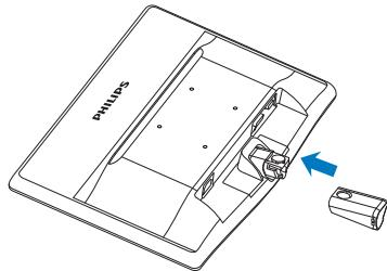
3. 請用雙手緊握顯示器底座支架，並將底座支架確實裝入底座安裝座中。
