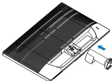
3. Tenere la base del monitor con entrambe le mani ed inserire con fermezza la base nel supporto.
