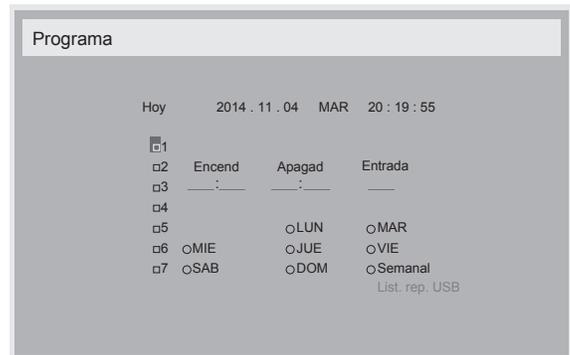
2. Pulse el botón [▲] o [▼] para seleccionar un elemento de programación (número de elemento 1 ~ 7) y, a continuación, pulse el botón [OK] para marcar el número de elemento.
