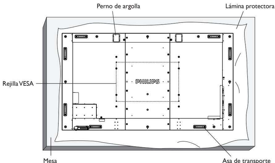
1. Extienda una lámina protectora sobre una mesa, por ejemplo la que envolvía a la pantalla en el paquete, debajo de la superficie de la pantalla de forma que esta no se arañe.
