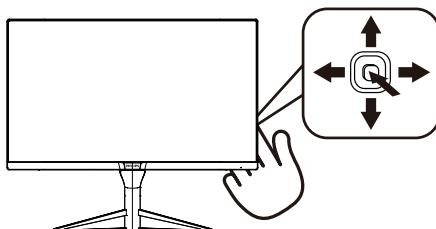
Da biste pristupili meniju na ekranu na ovom Philips monitoru, jednostavno upotrebite jedinstveni taster za prebacivanje na podnožju okvira monitora. Jedinstveno dugme radi kao džojstik. Da biste pomerali kurzor, jednostavno prebacujte taster u neki od četiri pravca. Pritisnite taster da biste izabrali željenu opciju.
