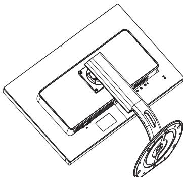
2. Відкрутіть монтажні гвинти, після чого від'єднайте ніжку від дисплея.
