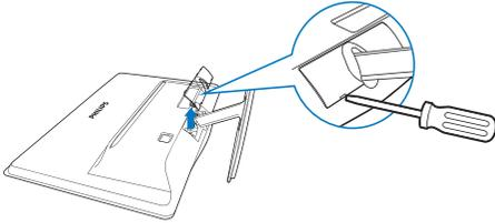
2. Lösen Sie die vier Schrauben, nehmen Sie die Basis anschließend vom Monitor ab.
