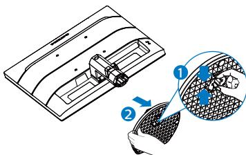
3. Вийміть гвинти з покриття петель.
