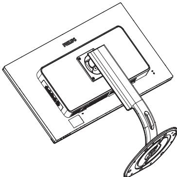
2. Slăbiți șuruburile de asamblare, apoi detașați gâtul de la monitor.
