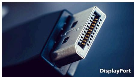
Интерфейс DisplayPort осуществляет прямую передачу цифровых сигналов с компьютера на монитор без преобразования. DisplayPort превосходит стандарт DVI и полностью поддерживает передачу данных с помощью 15-метрового кабеля со скоростью 10,8 Гбит/с.
