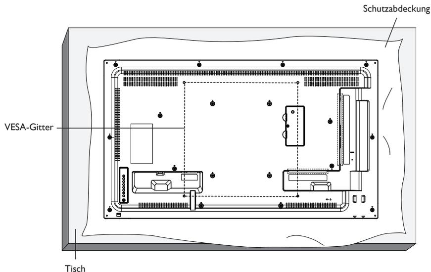
1. Legen Sie die Schutzabdeckung, die bei Lieferung um das Anzeigergerät gewickelt war, auf einem Tisch unter der Bildschirmoberfläche aus, damit der Bildschirm nicht zerkratzt.
