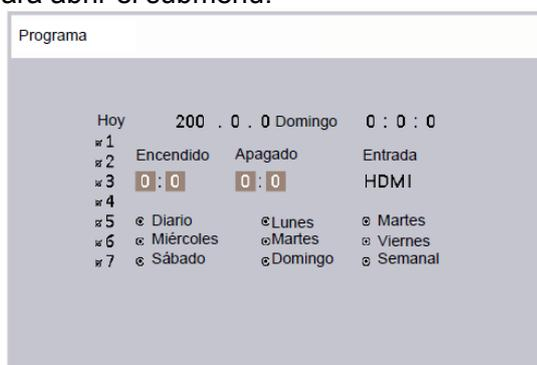
2. Pulse el botón **UP/DOWN** para seleccionar un elemento del programa (elemento 1 hasta elemento 7), y pulse el botón **PLUS**.
